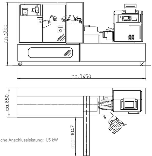
Gewicht ca. 1.650 kg, elektrische Anschlussleistung: 1,5 kW
