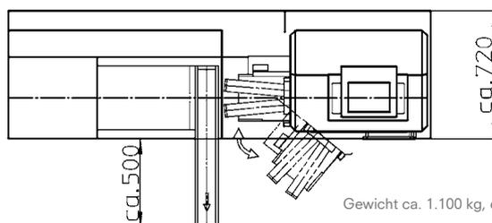
Gewicht ca. 1.100 kg, elektrische Anschlussleistung: 1,2 kW
