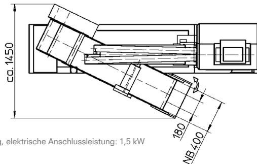
Gewicht ca. 460 kg, elektrische Anschlussleistung: 1,5 kW
